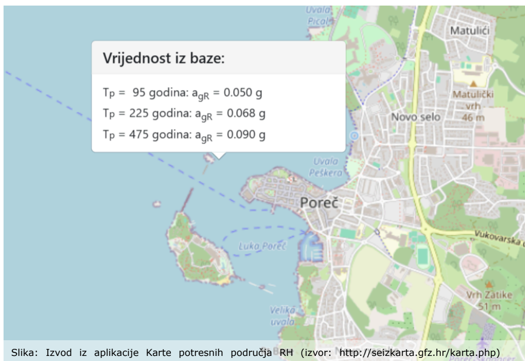
Slika: Izvod iz Karte potresnih područja RH; poredbeno vršno ubrzanje tla tipa A izraženo u jedinicama grav.ubrzanja za povratni period od 95 i 475 godina, izvor: http://seizkarta.gfz.hr/karta.php
